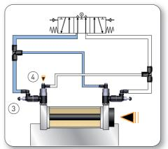
Il distributore alimenta alternativamente le 2 camere del cilindro, la connessione del pilotaggio (1) è raccordata all'alimentazione della camera opposta tramite un raccordo a Te. La velocità del cilindro è regolata allo scarico dal regolatore (2).
